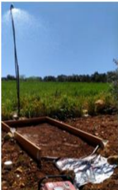
الشكل (2) جهاز المطر المصطنع
