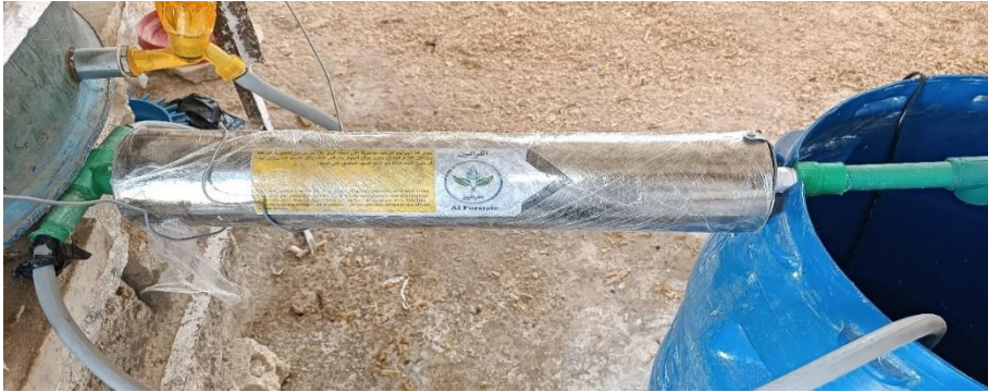
الشكل (2): جهاز مغنطة الماء المستخدم في التجربة.
