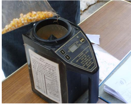
الشكل (2) : جهاز (Corporation Auburn 62615 USA) لقياس الرطوبة
