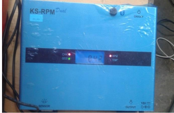
الشكل (7): جهاز قياس سرعة دوران المحرك المستخدم.
