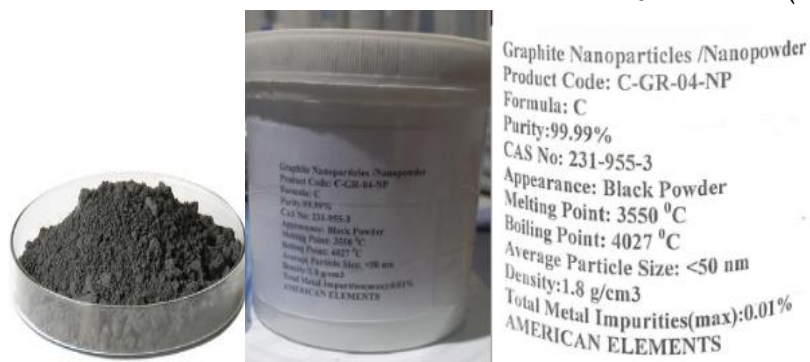
الشكل (2): مواصفات الغرافيت النانوي المستخدم
