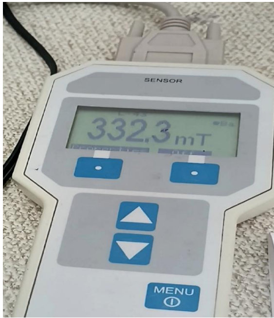
الشكل (1): قياس شدة الحقل المغناطيسي لجهاز المغنطة.
