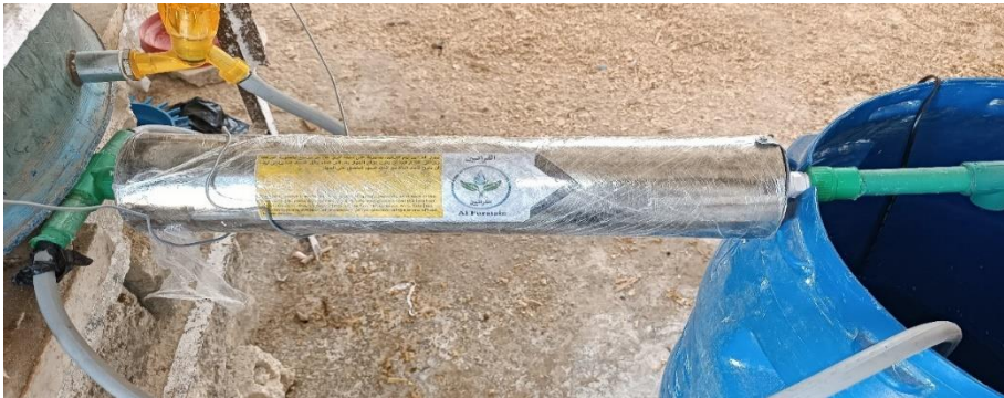
الشكل (2): جهاز مغنطة الماء المستخدم في التجربة.
