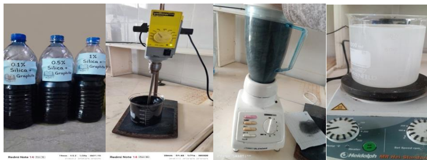
الشكل (10): طرق الخلط المتبعة في تحضير السوائل النانوية والعينات المركزة
