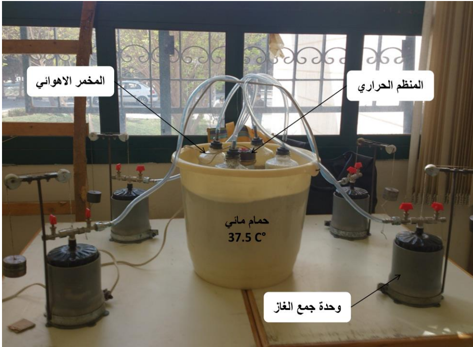
الشكل (2) وحدة التخمير اللاهوائية المخبرية المستخدمة في التجربة
