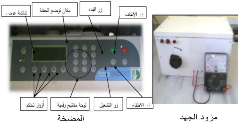
الشكل (3): أجزاء جهاز الغزل الكهربائي المستخدم في تصنيع الشبكات النانوية المغزولة كهربائياً.
