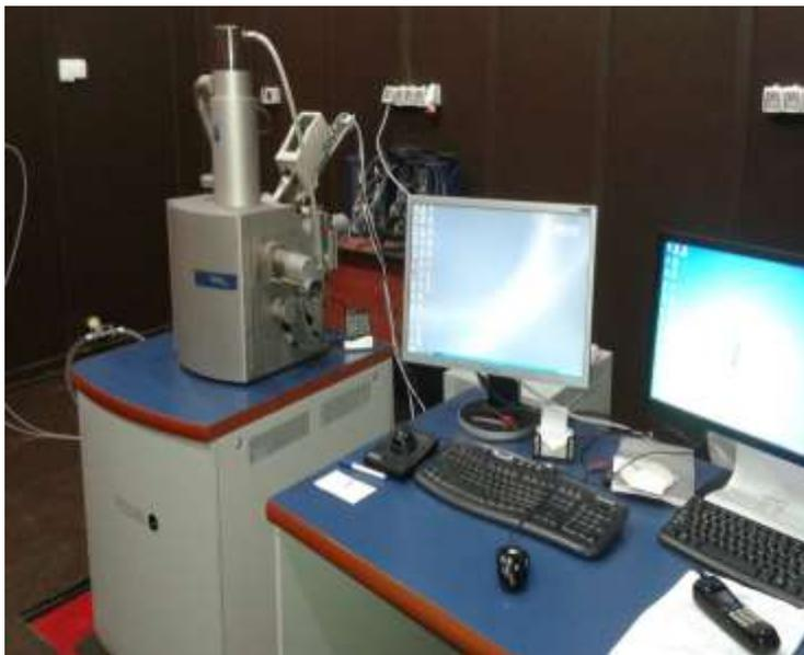
الشكل ( 5 ) المجهر الالكتروني الماسح في هيئة الطاقة الذرية بدمشق VEGA II
