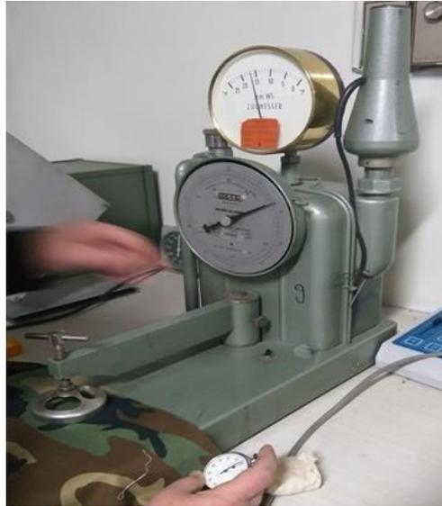
الشكل رقم (11) جهاز قياس نفوذية الهواء
