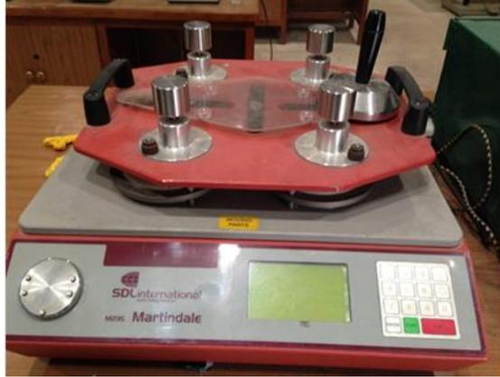
الشكل رقم (10) جهاز قياس مقاومة الاحتكاك
