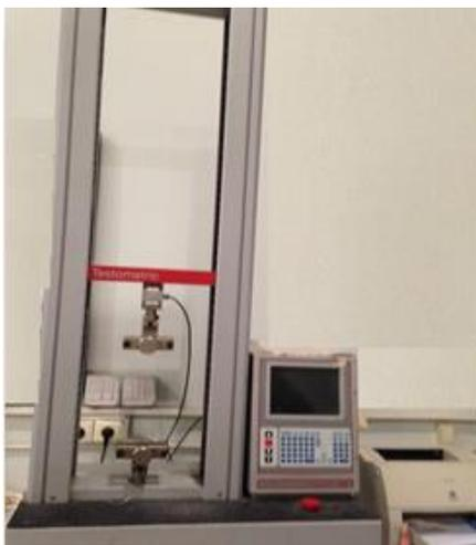
الشكل رقم (9) جهاز قياس قوة الشد
