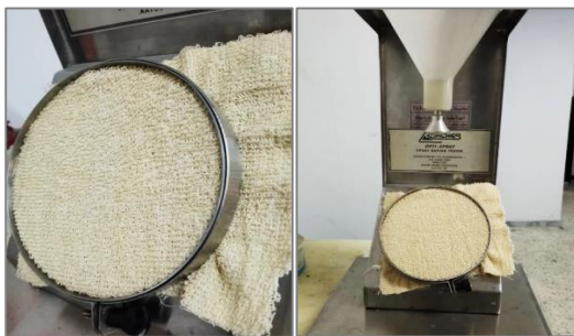
الشكل (7): اختبار الترطيب السطحي
