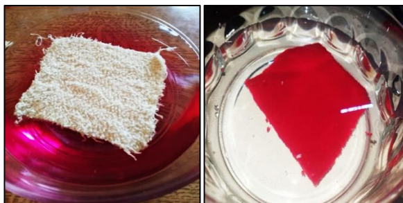
الشكل (9): إجراء اختبار الغمر للعينات
