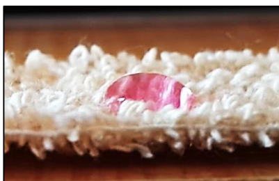
الشكل (10): إجراء اختبار القطرة (زمن الترطيب)
