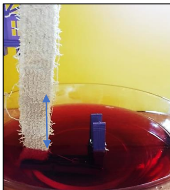
الشكل (11): كيفية اختبار سرعة نقل السائل
