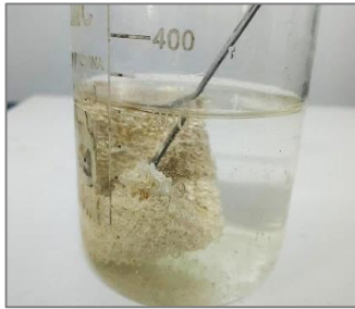
الشكل (6): طريقة اختبار الامتصاص الساكن في المخبر
