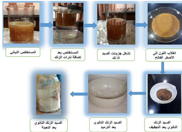
الشكل(1): مراحل اصطناع جسيمات أكسيد الزنك النانوي حيوياً
