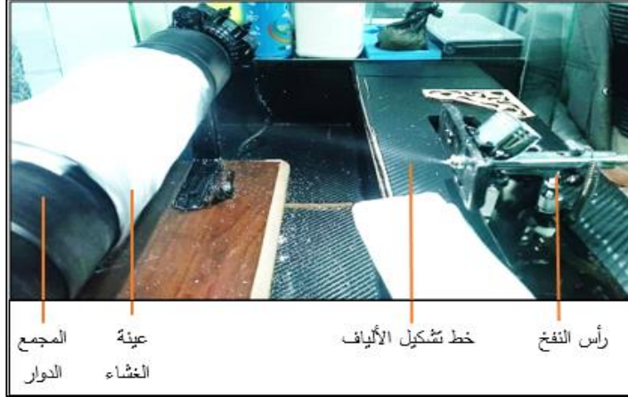
الشكل (5): عملية تشكيل الأغشية بتقنية الغزل بالنفخ
