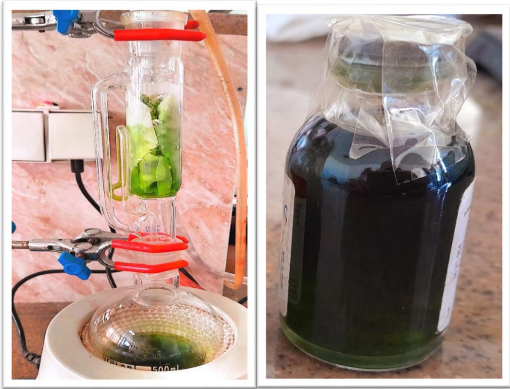
الشكل (3) عملية الاستخلاص باستخدام ساكسوليه
