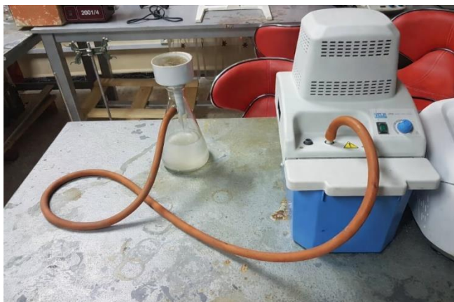
الشكل (7) عملية ترشيح مياه الملوثة
