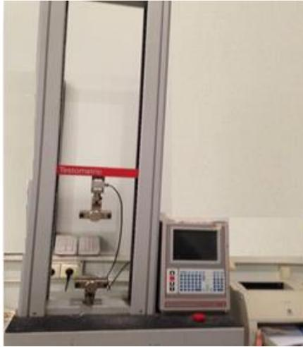
الشكل رقم (9) جهاز قياس قوة الشد
