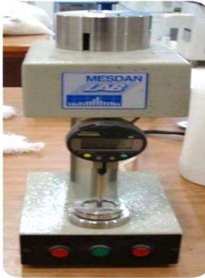
الشكل (3) جهاز قياس السماكة
