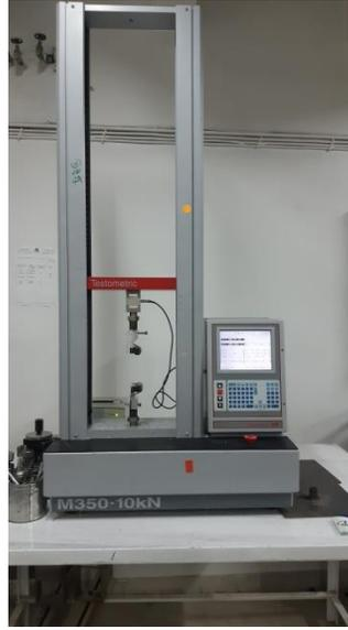
الشكل (9): جهاز الشد Testometer
