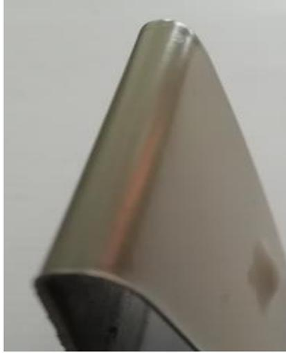
الشكل (5) اختبار مقاومة الثني على طبقة الطلاء
