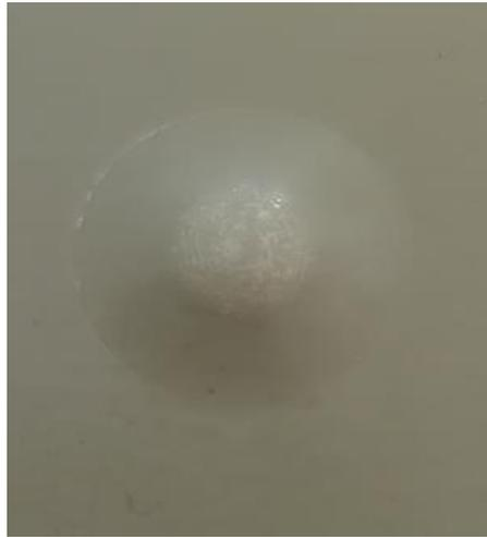
الشكل (6) اختبار تأثير مقاومة الصدم على طبقة الطلاء
