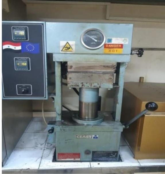
الشكل (1) جهاز المكبس الحراري
