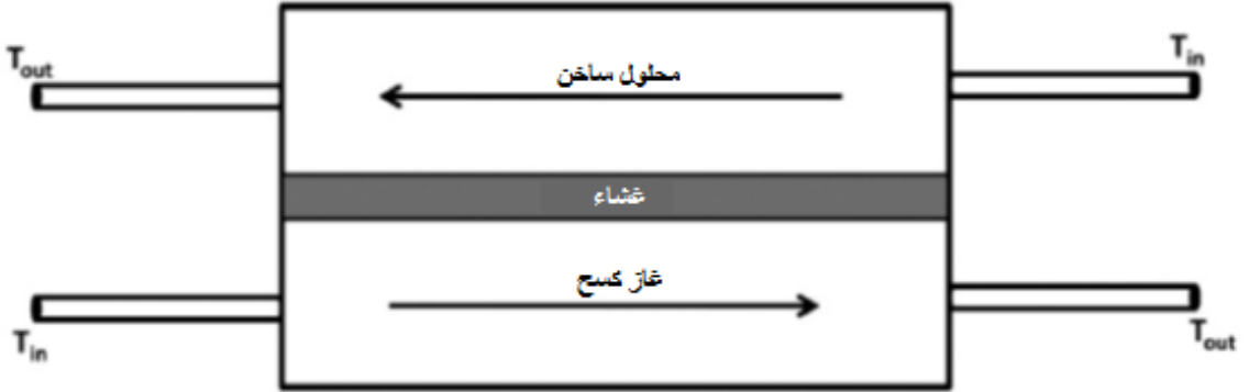
الشكل (6): التقطير الغشائي بالكسح الغازي (SGMD).
