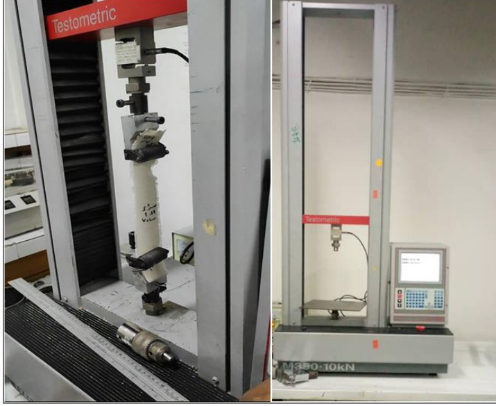
الشكل (2):جهاز اختبار قوة القطع M350-10KN
