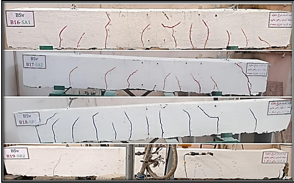
الشكل (13) شكل انهيار الجوائز المدعمة على الوجهين الجانبيين
