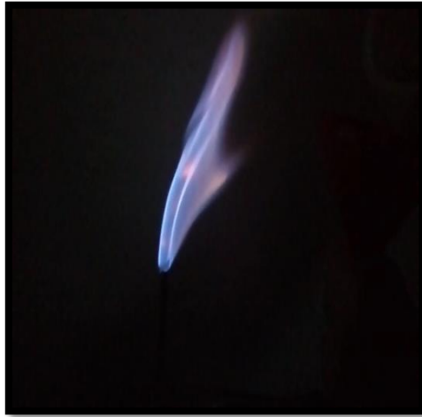
الشكل (8) اللهب الناتج عن احتراق الغاز الحيوي الناتج عن الهضم اللاهوائي للحمأة الأولية
