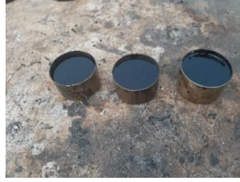
الشكل رقم (3) تجربة الغرز بدرجة حرارة 25°C للبيتومين غير المعدل A
