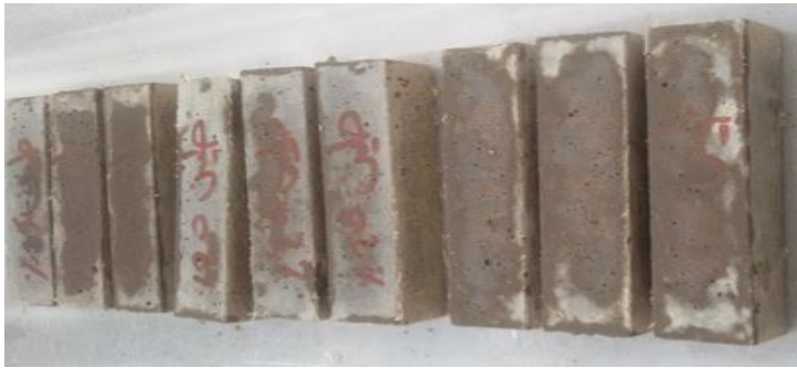
الشكل (٦) العينات المرجعية والمعدلة بالظمي ٢٠% لاختبارها حسب EN 196-1
