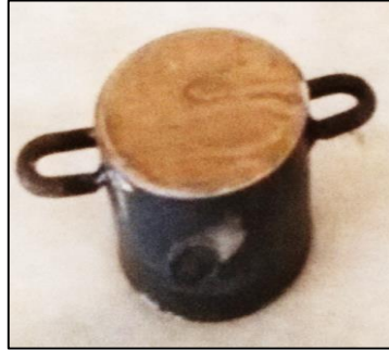
الشكل (٥) اختبار القوام حسب EN 1170-1
