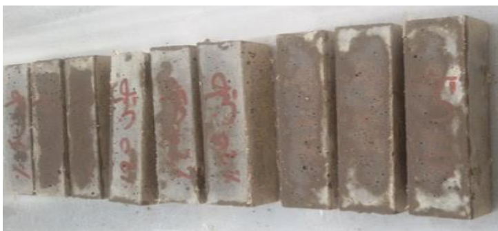
الشكل (٦) العينات المرجعية والمعدلة بالطمي ٢٠% لاختبارها حسب EN 196-1
