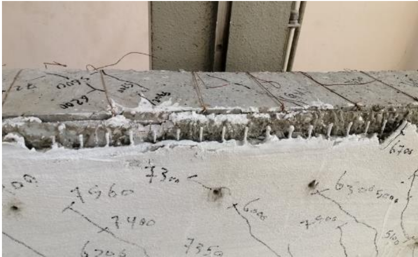
الشكل (15) نمط انهيار الجانز BR4 تحت تأثير قوى الفتل
