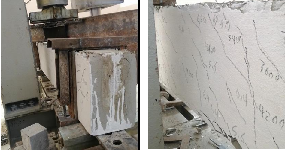
الشكل (11) نمط انهيار الجانز المدعم BRS-2 تحت تأثير قوى الفتل
