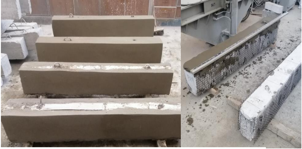
الشكل (6) الجوائز المختبرة بعد تدعيمها بالفيروسمنت وفق المتحولات المدروسة
