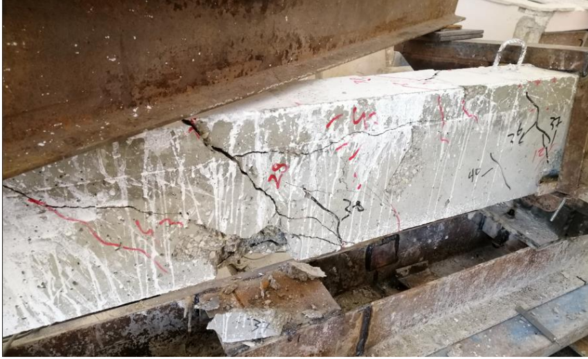
الشكل (9) نمط انهيار الجوائز المرجعي BR0 تحت تأثير قوى الفتل
