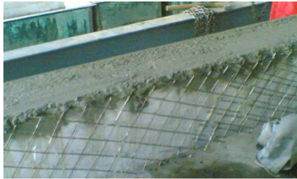
الشكل (1) مكونات طبقة الفيروسمنت والمقطع العرضي للجائز المدعم بالفيروسمنت
