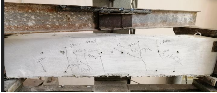
الشكل (13) نمط انهيار الجانز المرجعي BRS-3 تحت تأثير قوى القتل
