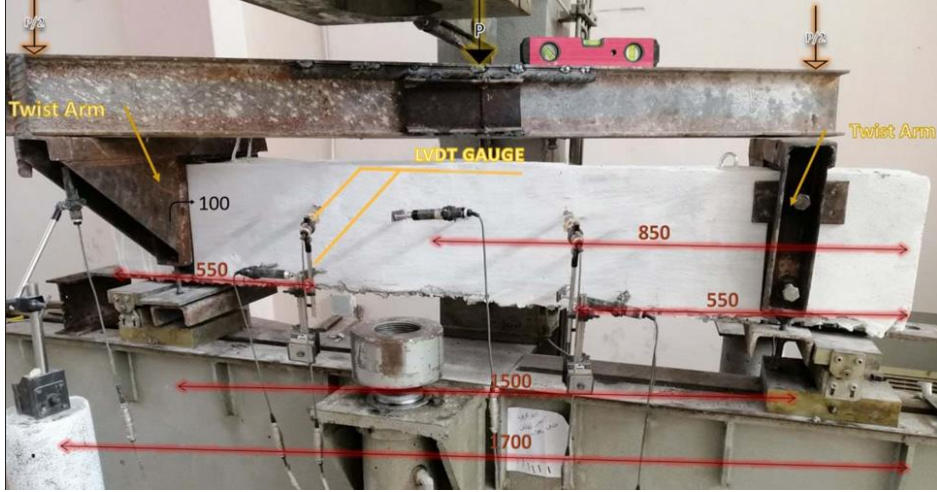
الشكل (8) اختبار الجانز على الفتل على الجهاز المعدل مع مواضع الحساسات
