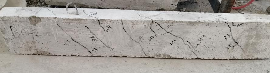
الشكل (8) نمط انهيار الجانز المرجعي BR0 تحت تأثير قوى الفتل
