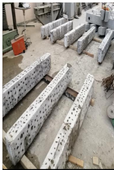
الشكل (4) مراحل تنفيذ الروابط باستخدام SBR ووباستخدام روابط القص وتثبيت شبك الاسلاك
