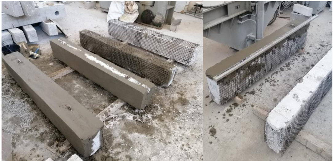
الشكل (5) الجوائز المختبرة بعد تدعيمها بالفيروسمنت وفق المتحولات المدروسة
