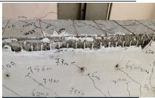
الشكل (12) تشكل التشققات وتطورها في الجانز BRS-2 تحت تأثير قوى الفتل
