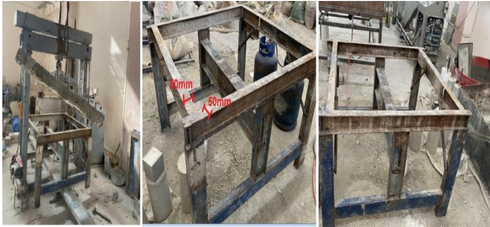
الشكل ( 3 ) طاولة الاستناد للبلاطات المجربة وعرض المساند
