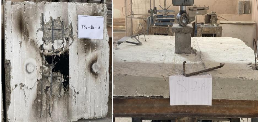
الشكل (20) نمط التشققات للبلاطة واختراق العمود للبلاطة FS2-2h-A
