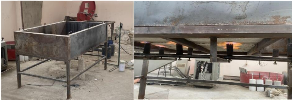
الشكل (6) الفرن المستخدم لحرق البلاطات الفطرية
