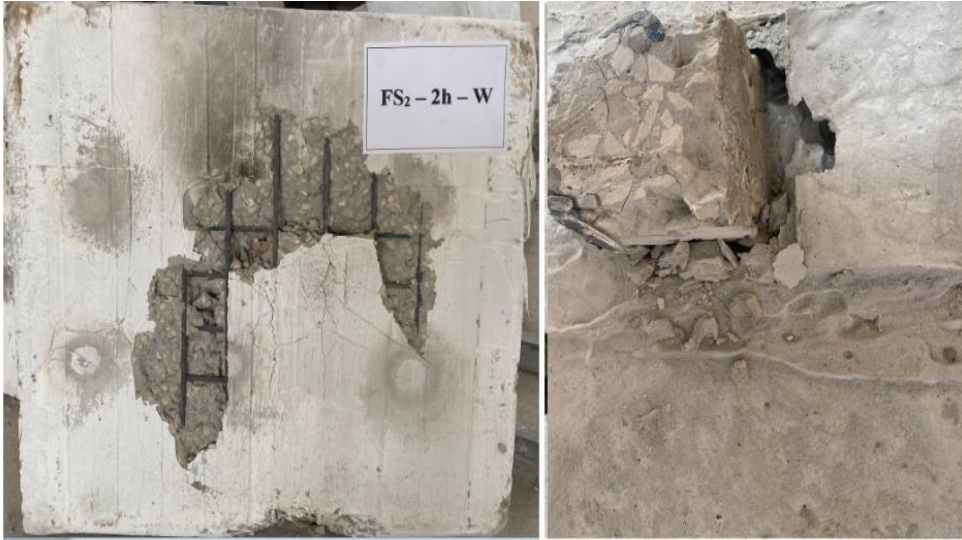
الشكل (18) نمط التشققات واختراق العمود للبلاطة FS2-2h-W
