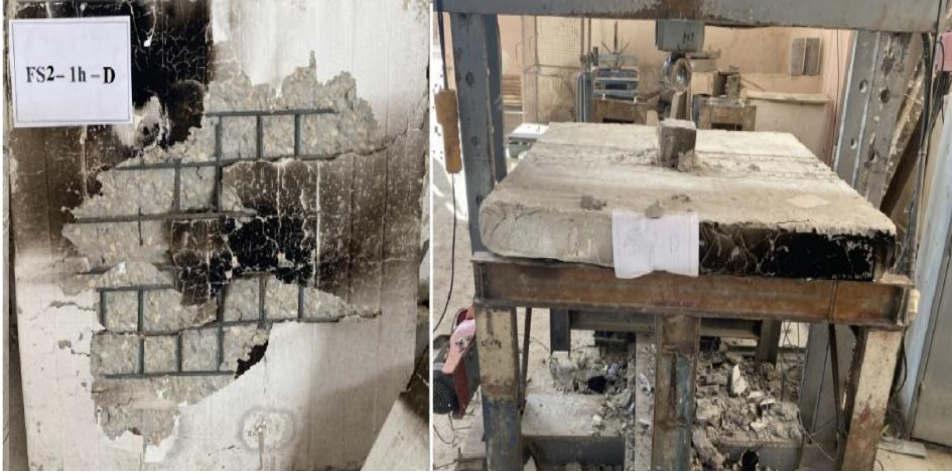
الشكل (21) نمط التشققات للبلاطة واختراق العمود للبلاطة FS2-1h-D
