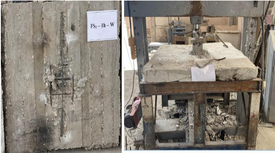
الشكل (17) نمط التشققات واختراق العمود للبلاطة FS2-1h-W
