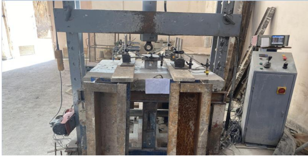
الشكل ( 2 ) جهاز تجريب القساطل (بعد التعديل) في مخبر البيتون المسلح في كلية الهندسة المدنية بجامعة حمص
