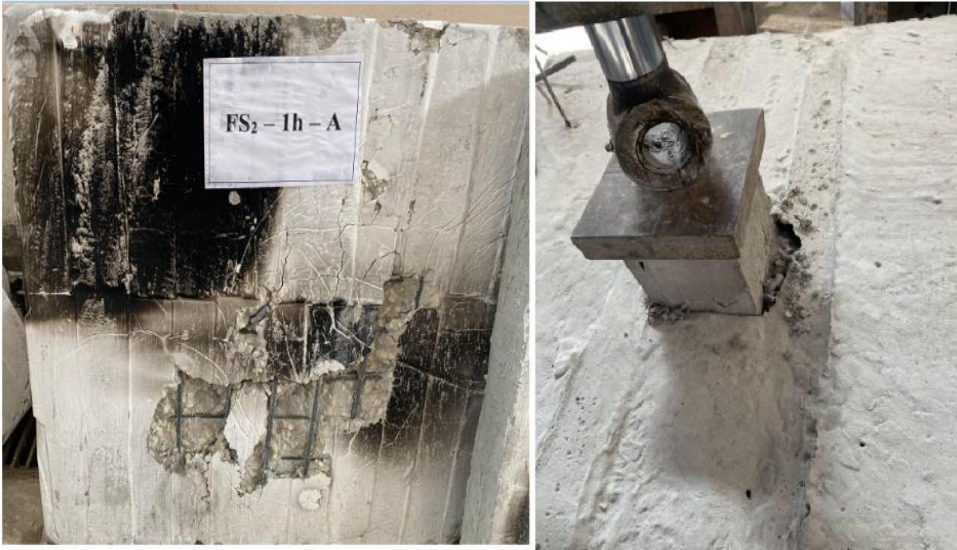
الشكل (19) نمط التشققات للبلاطة واختراق العمود للبلاطة FS2-1h-A
