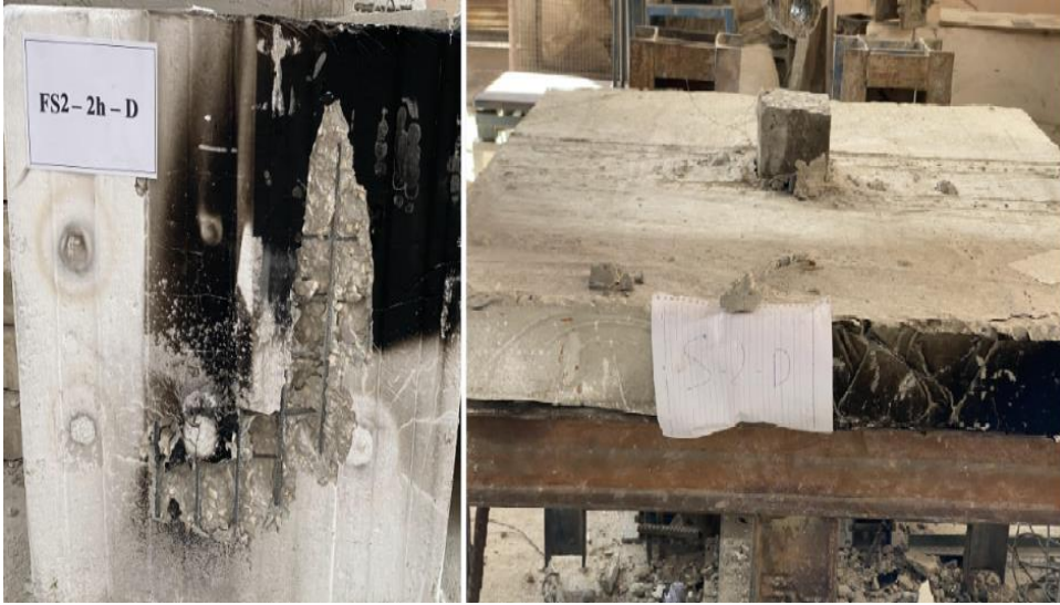
الشكل (22) نمط التشققات للبلاطة واختراق العمود للبلاطة FS2-2h-D
