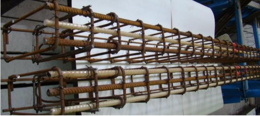
الشكل (4): شكل هياكل التسليح للجوائز البيتونية المسلحة بشكل هجين (بثلاثة قضبان 2 زجاجية GFRP و 1 فولاذي) أو (بثلاثة قضبان 1 زجاجي GFRP و 2 فولاذية) وهي بوضعية مقلوبة.
