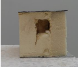
شكل (15): عيوب تقنية تصنيع الألواح
