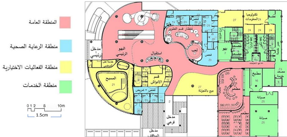
الشكل (19) مخطط الطابق الأرضي لمركز EKH لطب الأطفال - المصدر: www.archdaily.com بتصرف الباحث
