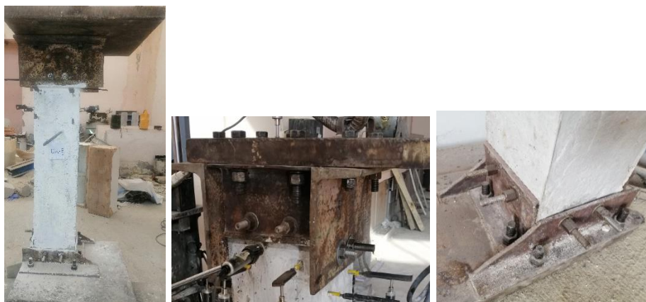
الشكل (3) تثبيت الصفيحة المعدنية العلوية والسفلية بالعمود عند التجربة
