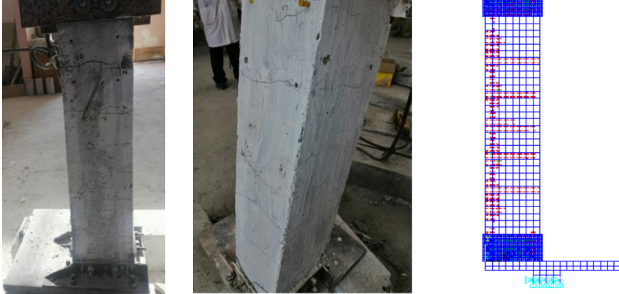
الشكل (6) الشقوق في منطقة الشد بالتجربة وبالنموذج الحاسوبي
