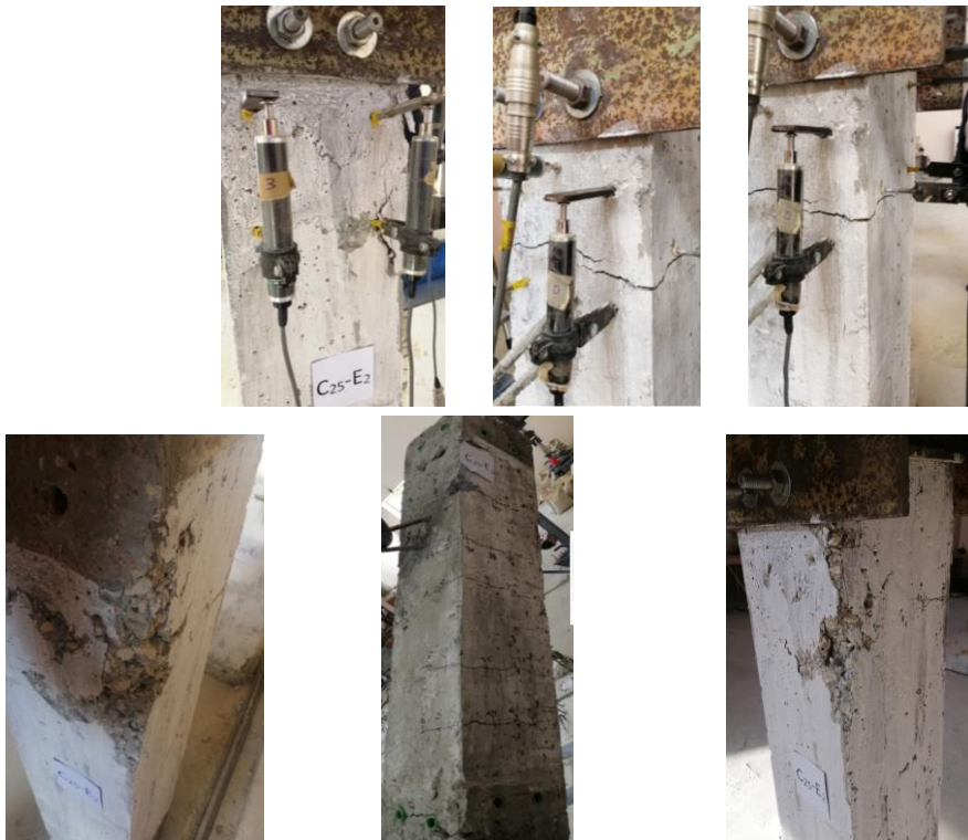
الشكل (8) مراحل انهيار العمود C25-E2
