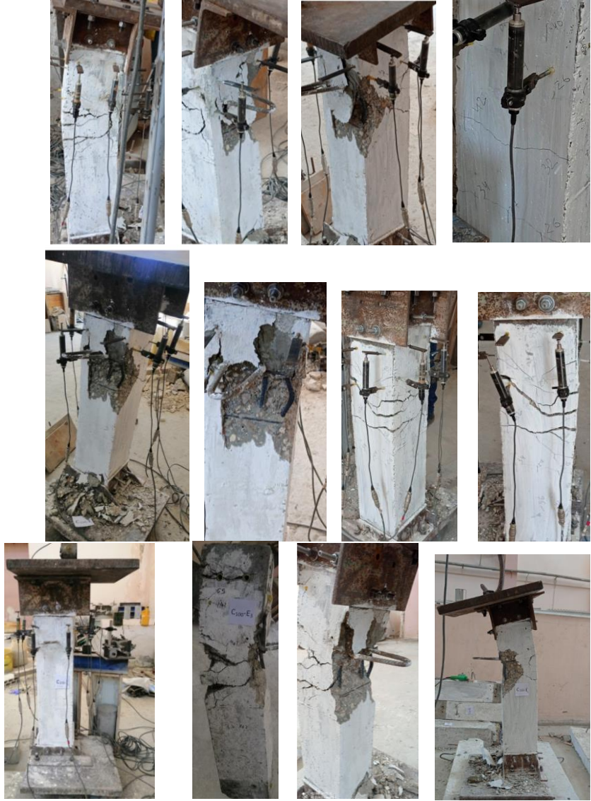
الشكل (9) مراحل انهيار العمود C100-E3
