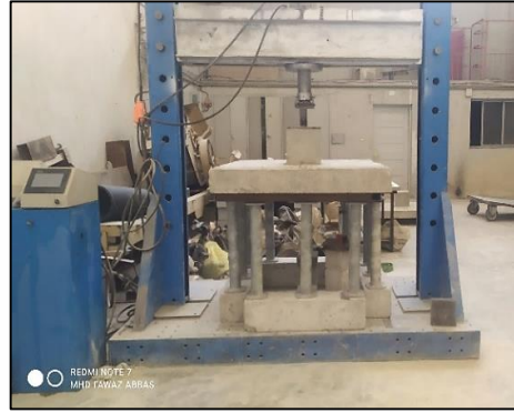
الشكل (9): جهاز التجربة وآلية الاختبار وشروط الاستناد للبلاطات
