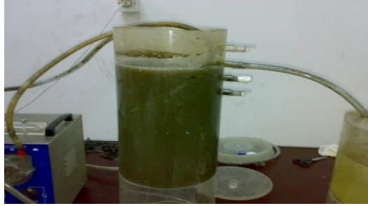
الشكل (12-3): مياه الصرف المخلوطة مع الحمأة أثناء عمل المفاعل
