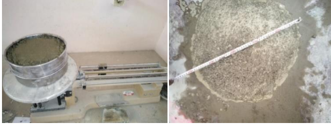
الشكل رقم (11) يوضح تجارب الخواص الطرية
