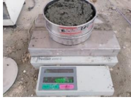
الشكل رقم (5) يوضح تجربة الانفصال
