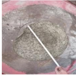
الشكل رقم (3) يوضح هبوط الانسياب
