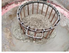
الشكل رقم (4) يوضح تجربة J-ring
