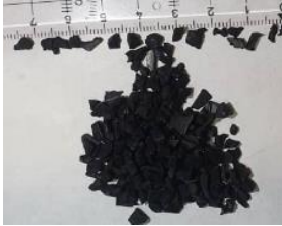
الشكل رقم (3) الحبيبات المطاطية المستخدمة في هذا البحث
