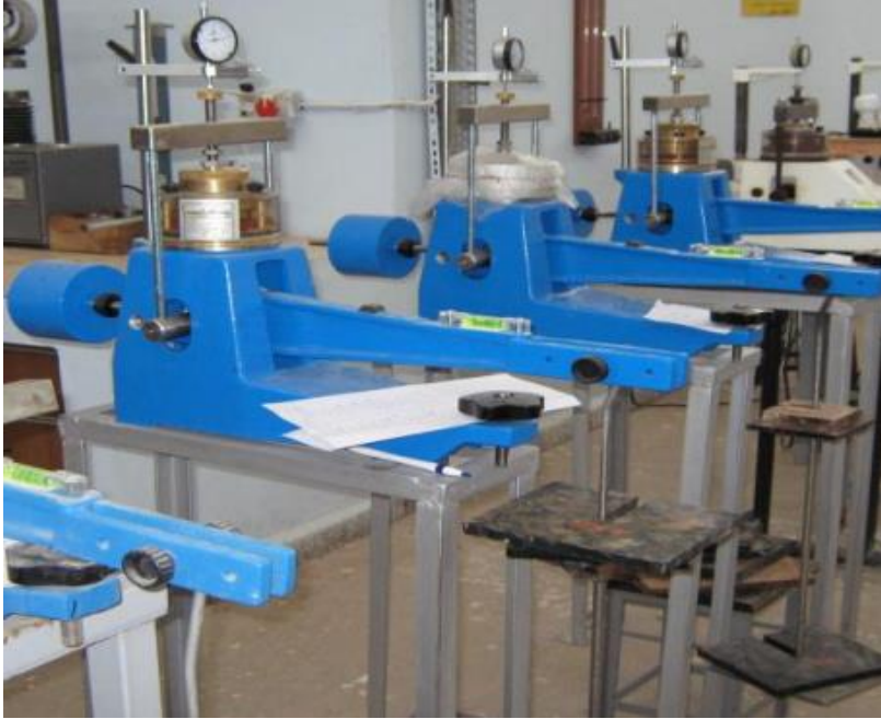
الشكل رقم (3) : عينات مشكلة من التربة الناعمة والمطاط لتجارب الانتفاخ في جهاز الآدومتر بجامعة حمص
