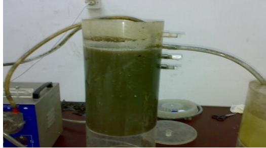
الشكل (3-12): مياه الصرف المخلوطة مع الحمأة أثناء عمل المفاعل
