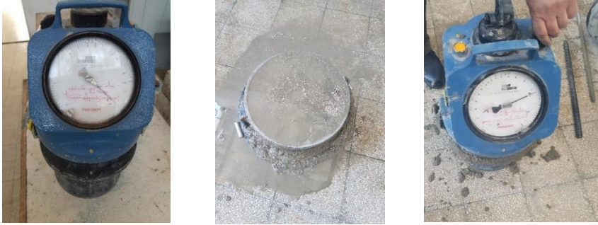
جهاز الضغط لمعرفة حجم الفراغات الهوائية في الخلطة الخرسانية الطازجة
