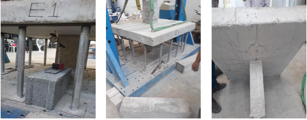
الشكل (14) آلية إنهيار العينات المقواة
