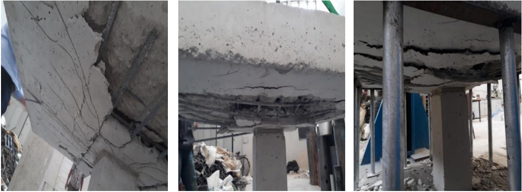
الشكل (11) آلية إنهيار العينات العادية
