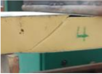
الشكل (5): نمط الانهيار القصي للنواة بزواوية 45 درجة [4]
