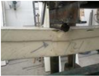
الشكل (6): نمط التشوه الموضعي الحاصل عند حدوث الانهيار مع
