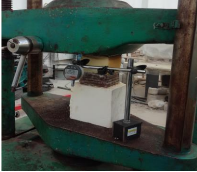
الشكل(8):الجهاز الأول للتحميل المباشر بالضغط
