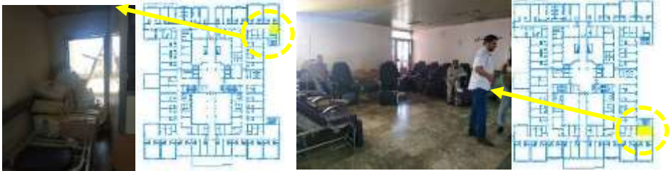
الشكل (33) يبين إلغاء دور ووظيفة درج الهروب في الوحدة. الشكل (34) بهو أمام درج الهروب.
