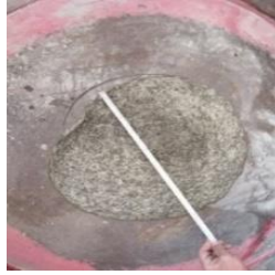
الشكل رقم (3) يوضح هبوط الانسياب
