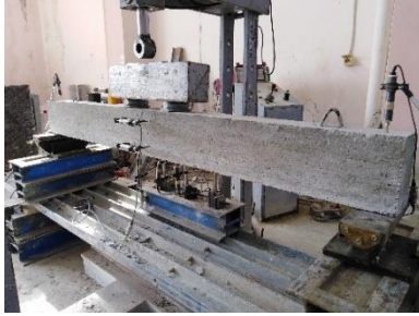
الشكل رقم (6) تطبيق الحمولة وتموضع الحساسات
