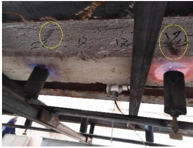
الشكل رقم (23) نتح المياه من سطح الجائز وتبخره
