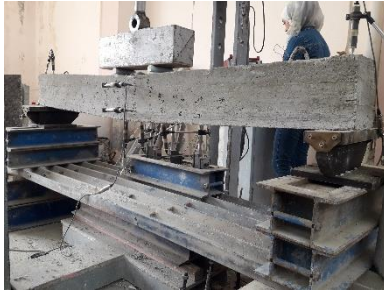
الشكل رقم (2) نظام الاستناد البسيط
