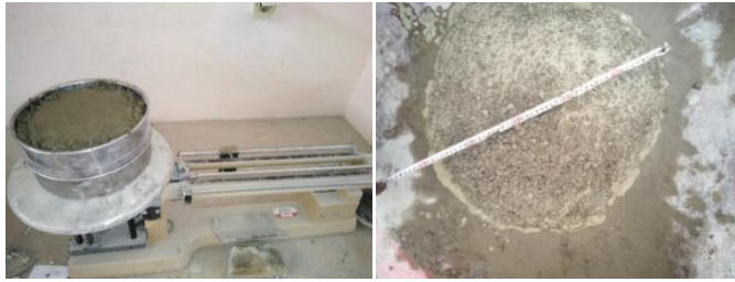
الشكل رقم (11) يوضح تجارب الخواص الطرية
