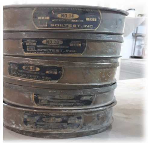
الشكل (4) المناخل المستخدمة لتجربة التحليل الحبي
