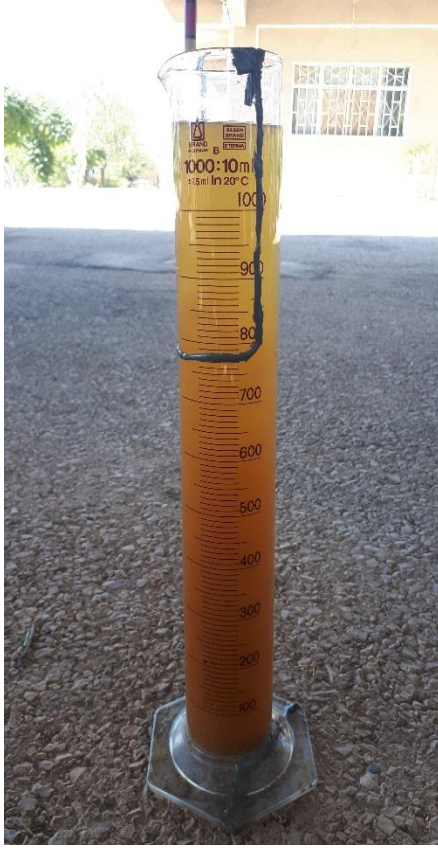
الشكل (11) مياه الغسيل العكسي الخارجة من الفلتر
