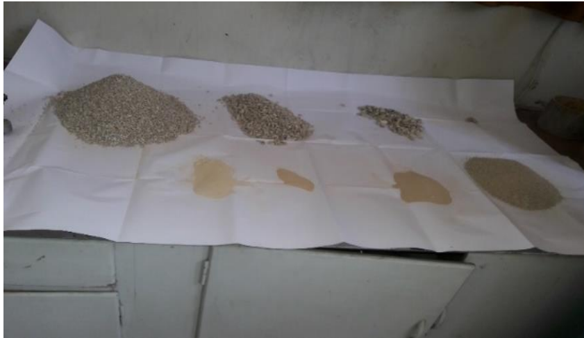
الشكل (4) عينات الحصويات المحجوزة على المناخل القياسية
