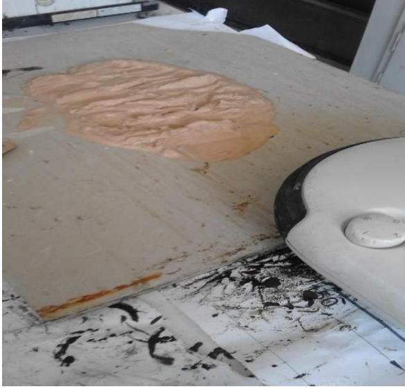
الشكل (2) عملية تجفيف البودرة بالهواء الساخن
