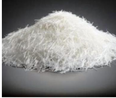
الشكل (3) : ألياف الفيبر جلاس المقطعة أو المفرومة
