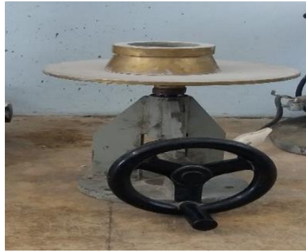
الشكل (6) : يوضح جهاز قياس سيولة المونة الإسمنتية
