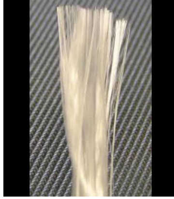
الشكل (1) : ألياف الفيبر جلاس الحبلية
