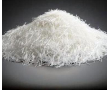
الشكل (3) : ألياف الفيبر جلاس المقطعة أو المفرومة
