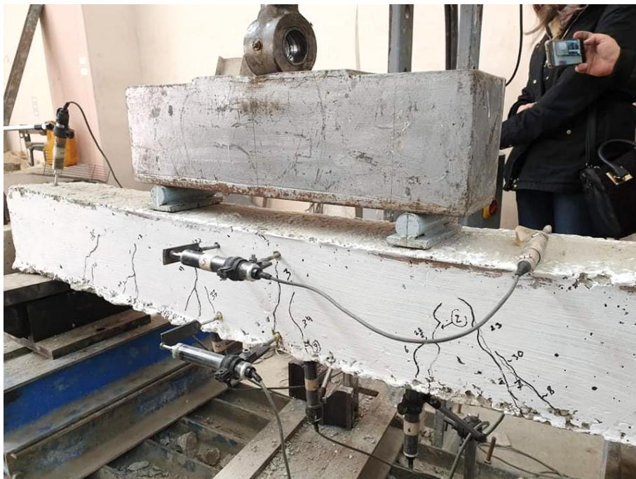
الشكل (10) : الجائز موضح عليه الحساسات، وجهاز التحميل (مخبر البيتون المسلح-كلية الهندسة المدنية-جامعة البعث)
