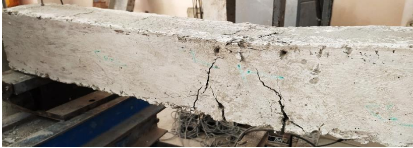
الشكل (24) : نمط انهيار الجائز B11 المسلح بقضبان فولاذية قطر mm (10)
