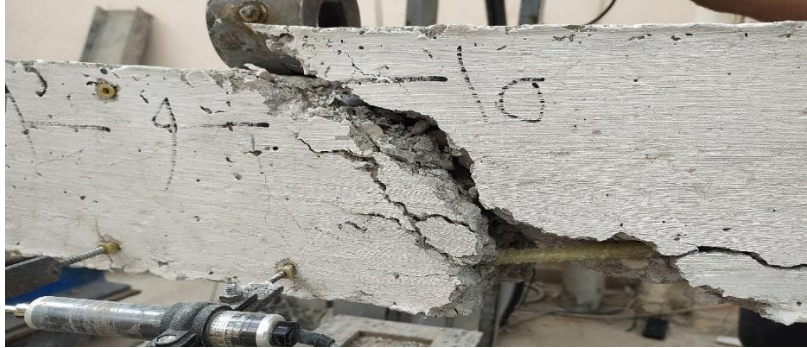
الشكل (25) : نمط انهيار الجائز B7 المسلح طولياً بقضبان GFRP قطر mm (10)
