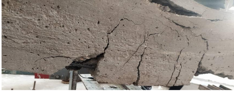
الشكل (23) : انهيار الجائز B1 بالانعطاف (تسليح 2T8 فولاذ)
