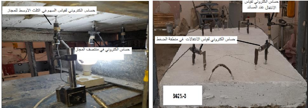
الشكل (11) مواقع الحساسات لقياس الانتقالات في منطقة الضغط والشد
