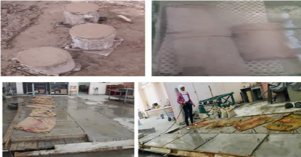
الشكل (9) صب البلاطات البيتونية المسلحة المراد اختبارها
