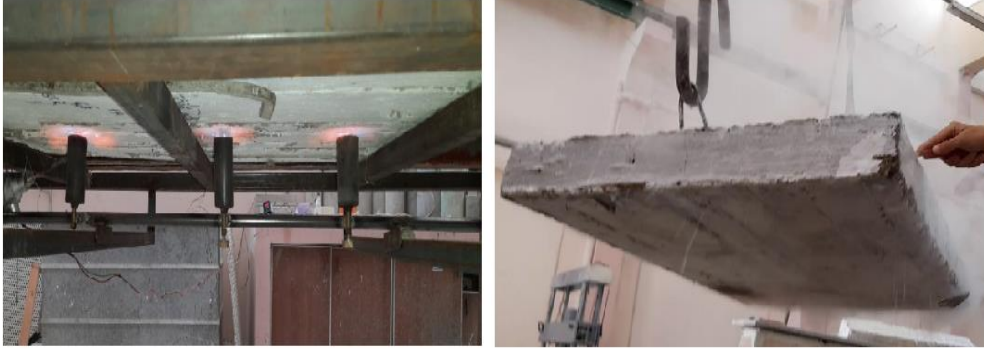
الشكل (16) البلاطة أثناء الحريق و عند التبريد
