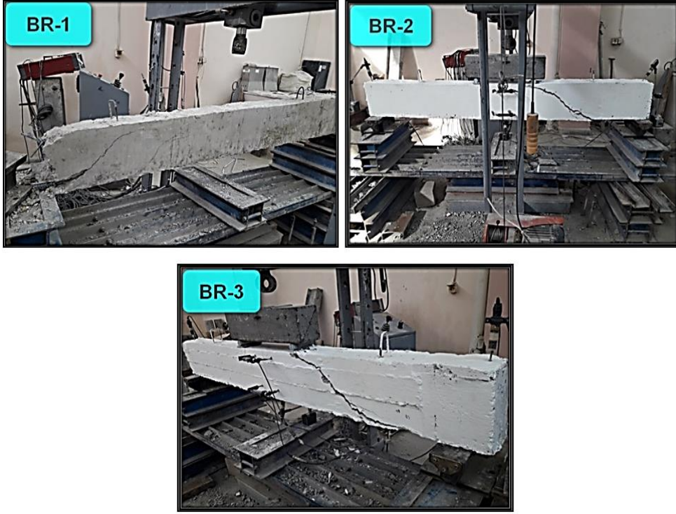
الشكل (7) شكل انهيار الجوائز المرجعية غير المُدعّمة
