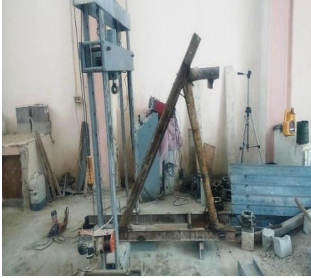
الشكل (17) طريقة تحميل العقدة.
