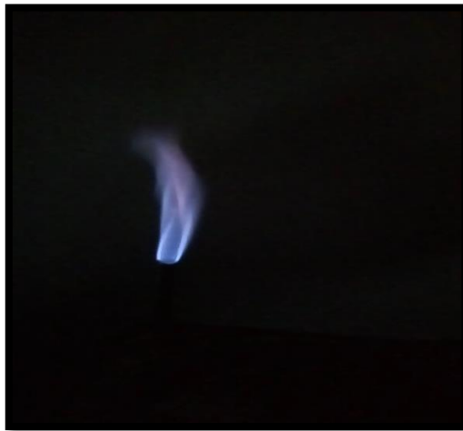
الشكل (9) اللهب الناتج عن احتراق الغاز الحيوي الناتج عن الهضم اللاهوائي للحمأة الثانوية
