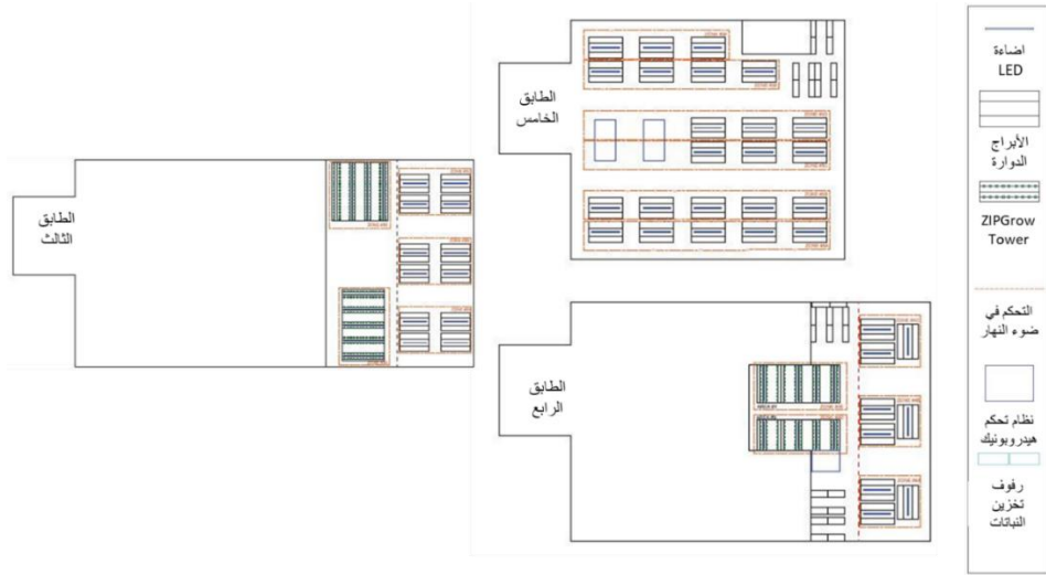
الشكل (3-52) توضع أبراج النمو في مزرعة Growing Power (الطاقة المتنامية) الرأسية المصدر: المرجع Growing Power Vertical Farm, 2015, p200
