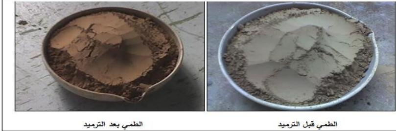
الشكل (٤) شكل الطمي قبل الترميد وبعده
